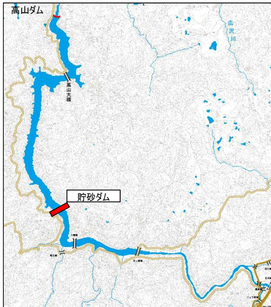
高山ダム貯砂ダム候補地
