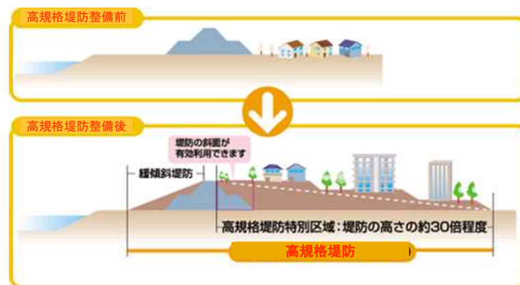
図 4.2-17 高規格堤防の概要
