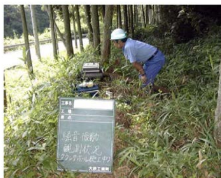
写真 3.2-3 騒音レベルの測定状況
