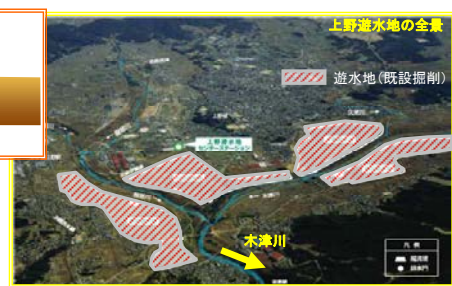
遊水地(既設掘削)：既設遊水地を掘り下げて遊水地の容量の増強を想定
