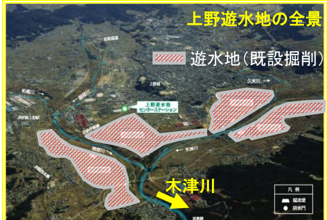
既設遊水地を掘り下げて遊水地の容量の増強を想定
