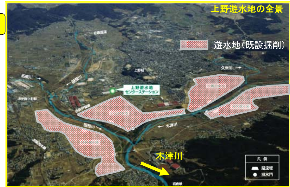
既設遊水地を掘り下げて遊水地の容量の増強を想定
