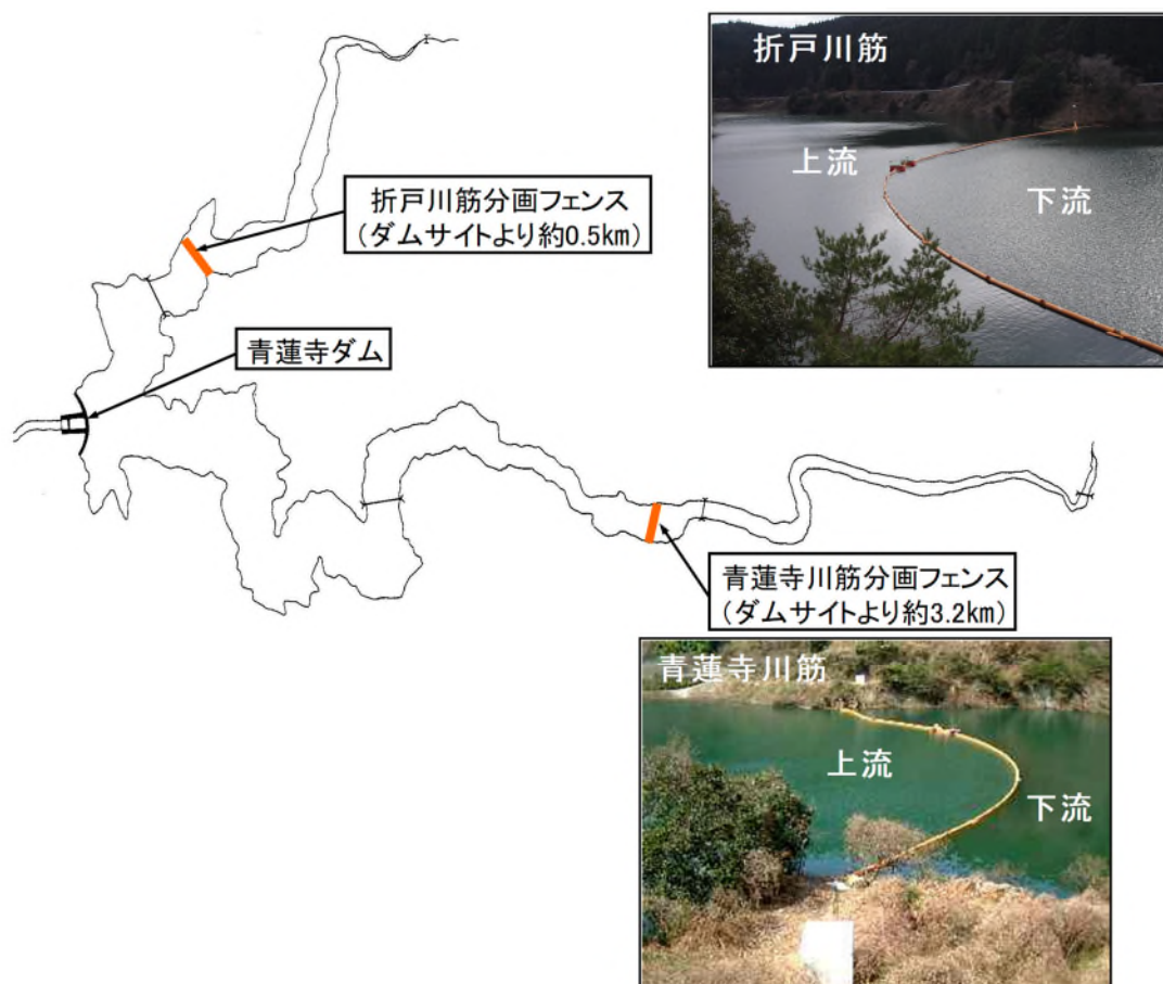
図 1.4.1-5 分画フェンスの設置状況と設置位置
