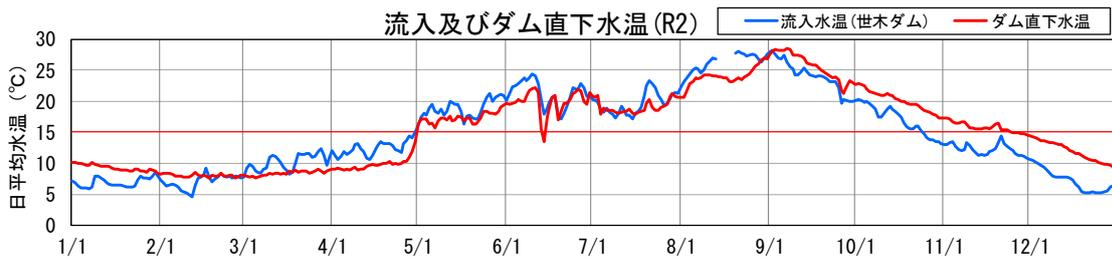
図 5.6.2-10 貯水池の水温鉛直分布と流入・放流水温 (令和 2 年)
