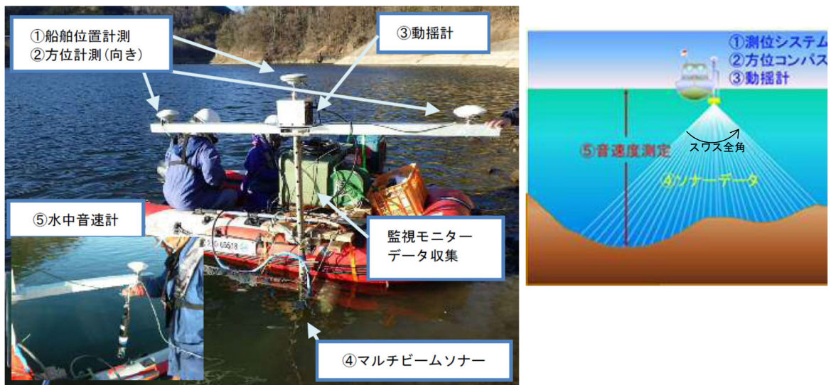
図 4.3-2 マルチビーム測深による観測
