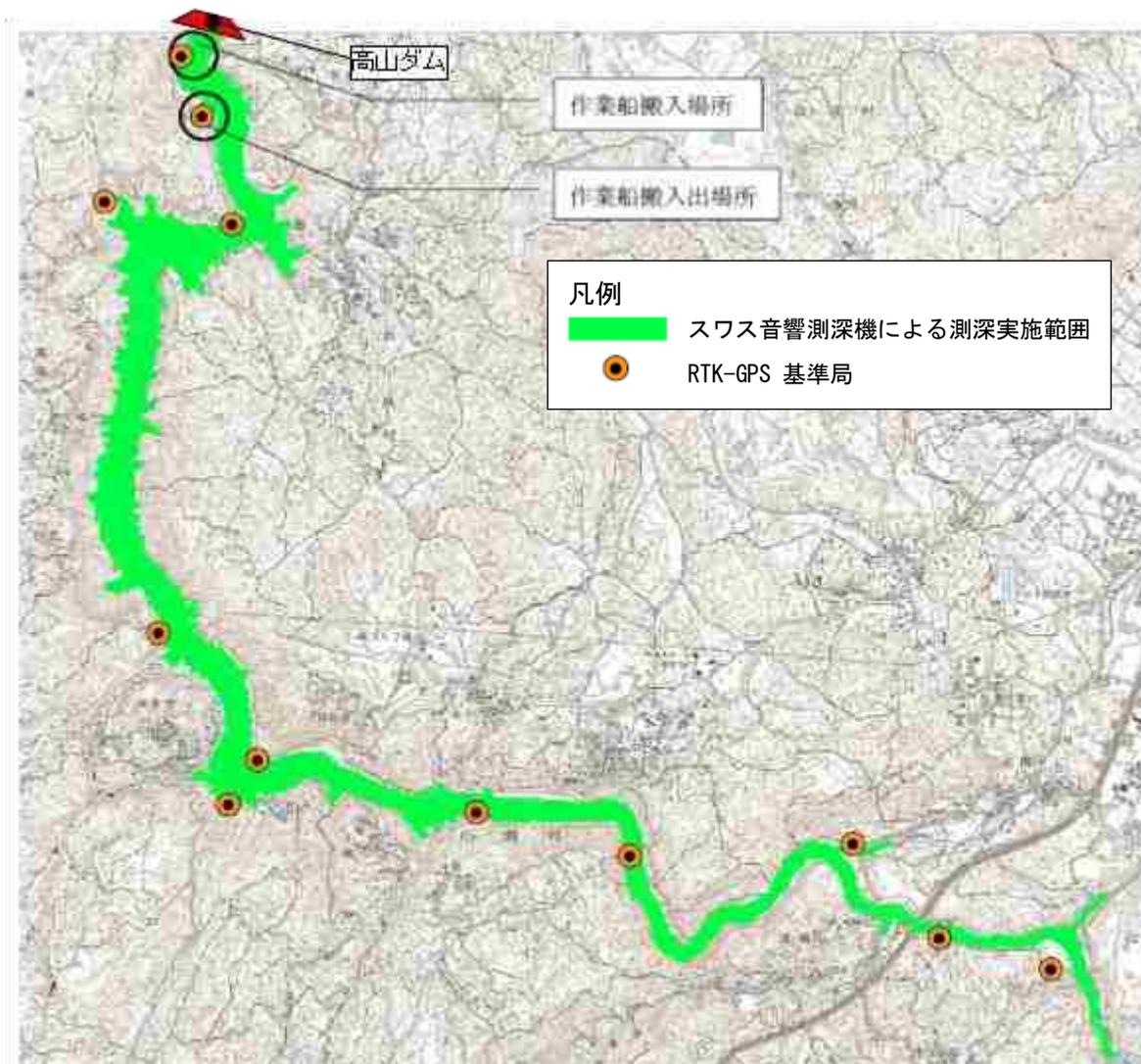
図 1.4.1-3 スワス音響測深機による測深範囲
