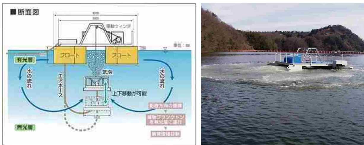
図 5.6.1-2 曝気循環設備
