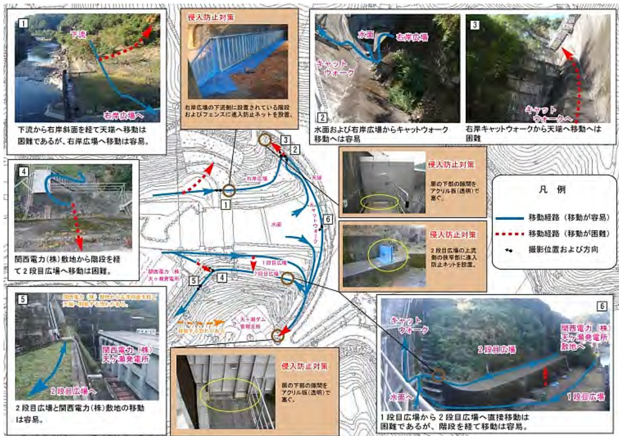
図 6.6-13 ヌートリア侵入防止対策実施状況
