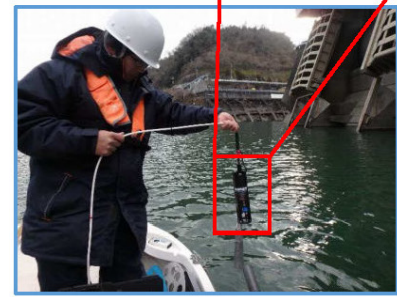
図 4.2-7 観測状況(左：測深作業、右：水中音速度計測)
