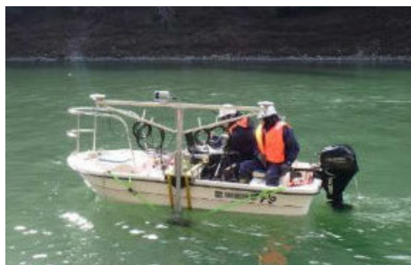
図 4.2-7 観測状況(左：測深作業、右：水中音速度計測)
