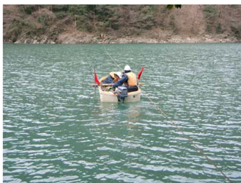
図 4.2-2 深浅測量作業状況
