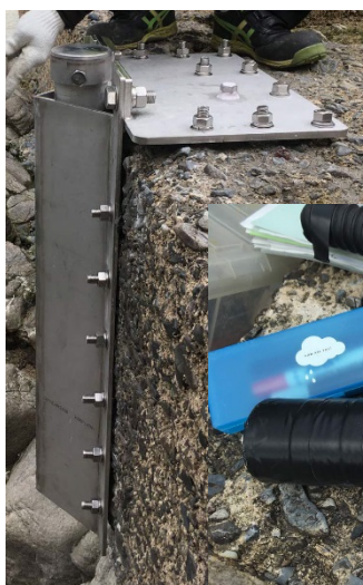
図 5.2-5(3) 鹿跳橋地点水質自動観測装置 (操作盤・センサー部・立面図)
