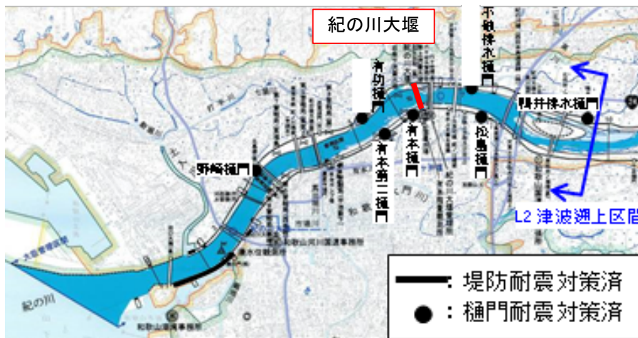
図 2.6-4 耐震対策の実施状況
