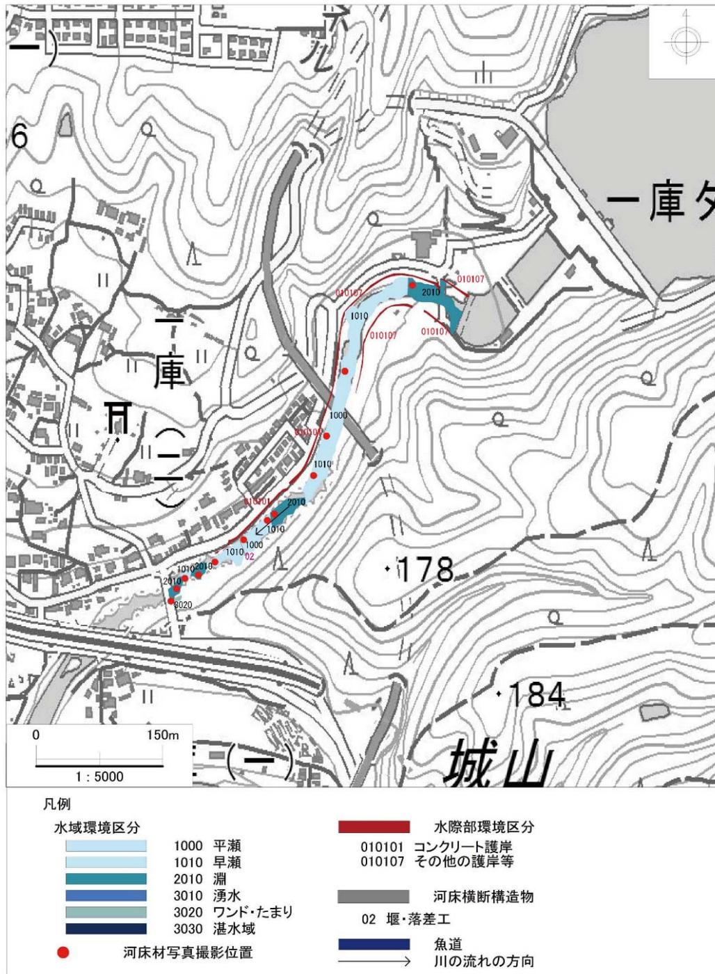
図 6.3-5 河床型および水際の状況（一庫大路次川 下流河川）
