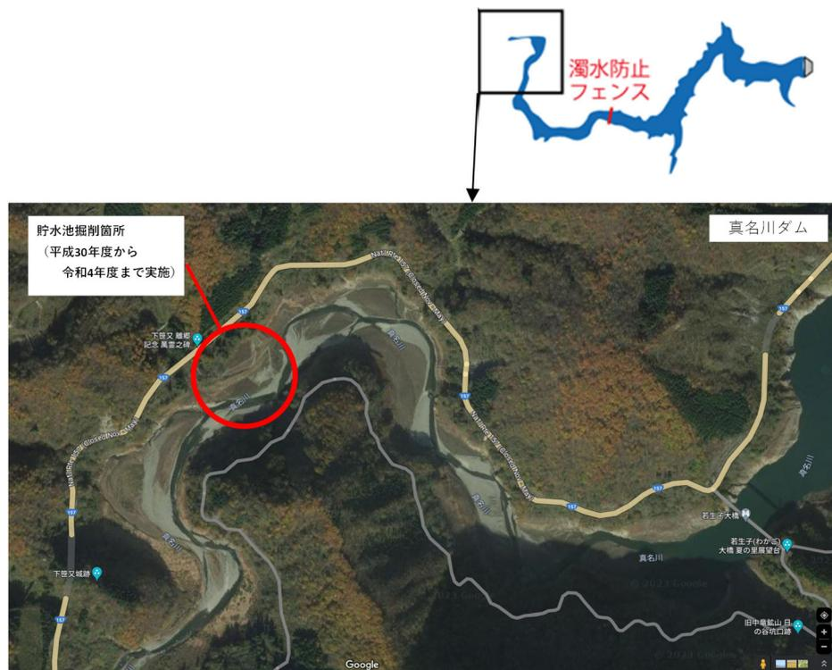
図 5.6-1 土砂掘削箇所
