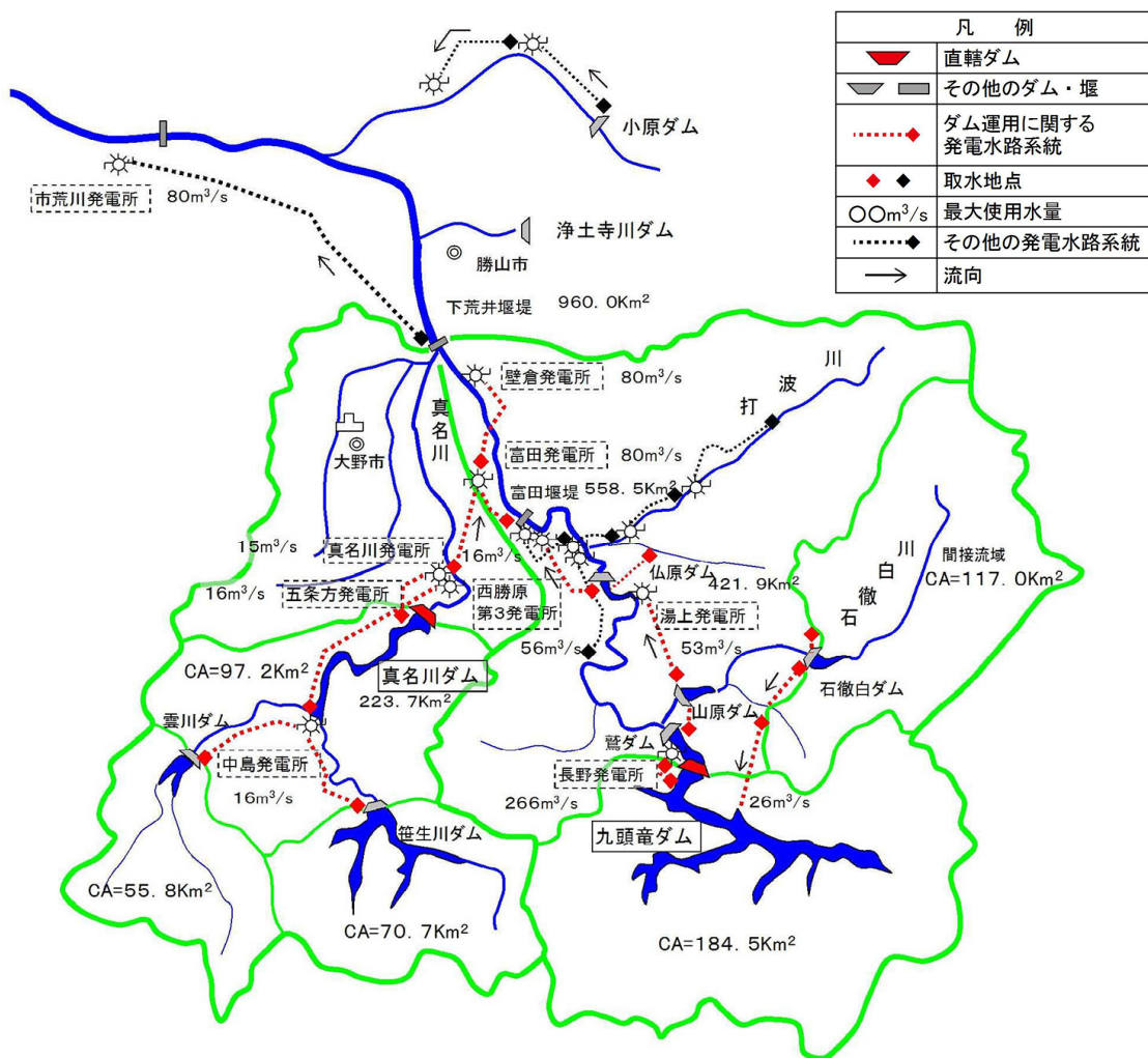
図 1.1-13 九頭竜川中上流域発電利水状況図
