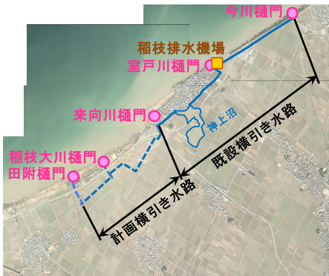
図 2.6-6 沿岸治水の現状（稲枝排水機場）
