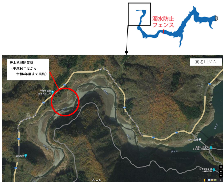
図 5.6-1 土砂掘削箇所
