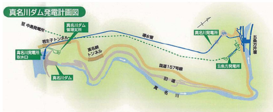
図 3.3-7 真名川ダム発電計画図（無水区間）
