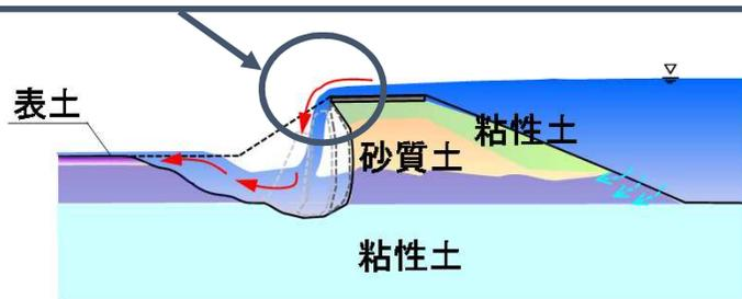
堤防天端をアスファルト等で保護した堤防では、ある程度の時間、アスファルト等が残っている。
