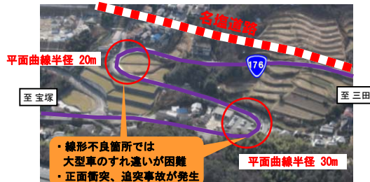
②線形不良箇所 (東久保地区)
