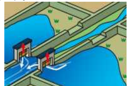
▲ 洪水後(遊水地内に溜めた水を排水)
