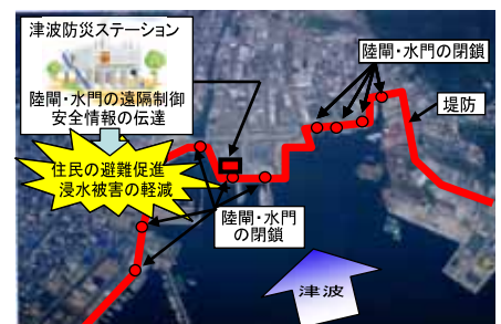
津波防災ステーション(例):福良港海岸(南あわじ市)
