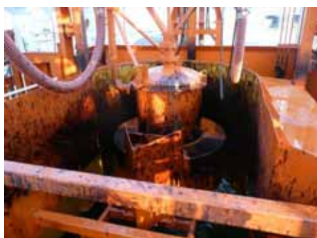
油回収器による回収状況(明石海峡貨物船衝突事故)
