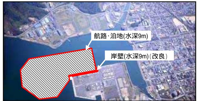
就航船舶の大型化に対応するため既存岸壁及び航路・泊地を増深改良します。
