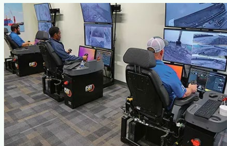
Cat Command リモートステーション (キャタピラー・ジャパン合同会社HPより)
