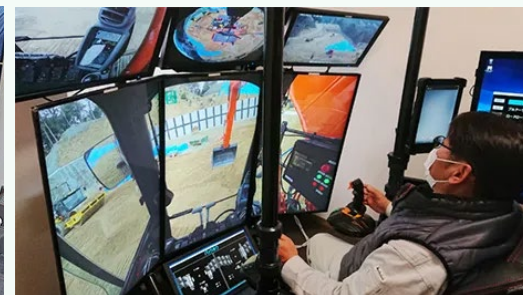
5Gを活用して3種類の建設機械を遠隔操縦 (日立建機日本株式会社HPより)
