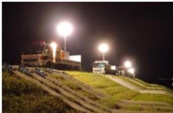
排水ポンプ車による緊急排水作業
