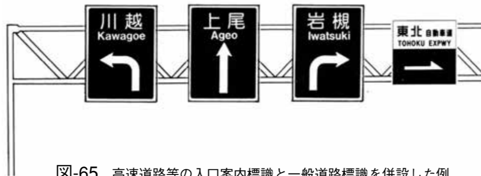
図-65 高速道路等の入口案内標識と一般道路標識を併設した例
