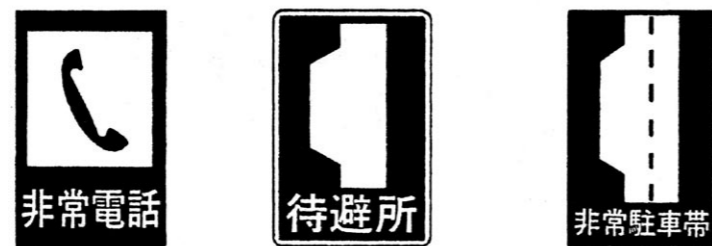
非常電話（116の2） 待避所（116の3） 非常駐車帯（116の4）
