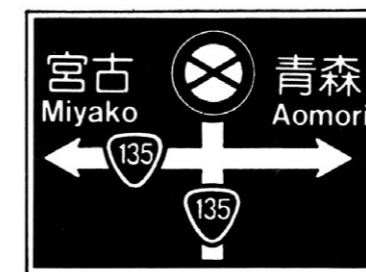
図-68 案内標識の中に規制標識のマークを記入した例
