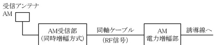
図 5-4-5 設備配置例 (同時増幅方式)
