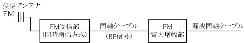
図 5-4-8 設備配置例 (同時増幅方式)
