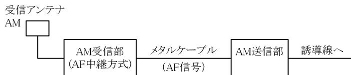
図 5-4-3 設備配置例 (AF 中継方式)
