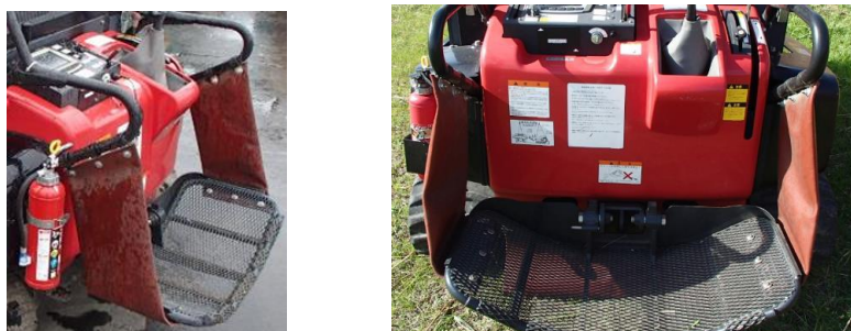
写真 1.13 搭乗ステップに取り付ける転倒・転落防止用ガード
