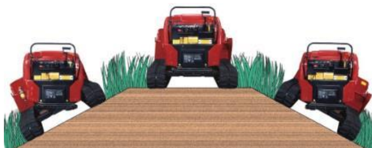
写真 1.8 運転席全体が左右に傾斜する搭乗ステップ
