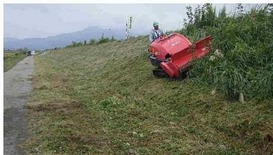
写真 1.10 住宅地との隣接や傾斜角度の変化は順路を調整
