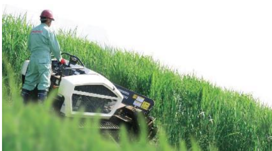
写真 1.9 堤防法面での除草作業状況（法尻から法肩への順路）
