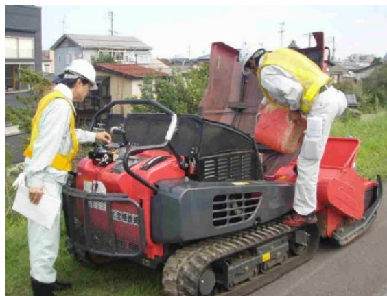
写真 1.1 燃料給油と各部の確認
