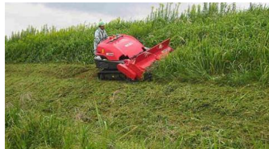
写真 1.9 堤防法面での除草作業状況（法尻から法肩への順路）
