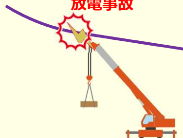
クレーンによる 放電事故
