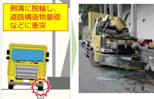
【事故概要】 10tダンプトラックにてトンネルズリ仮置き場に戻る途中、側溝に脱輪し、道路構造物基礎などに衝突した。
