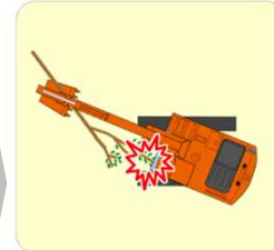
②伐採木がバケットから滑り落ち、運転席に飛び込み、操作レバーに接触
