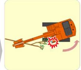
③車体が急激に旋回し、伐採木がオペレーターの左足を圧迫
