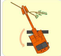
①伐採木をバケットに載せバックホウを旋回
