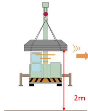
玉掛けが終わって荷を巻上げる場合はワイヤロープを緊張させた状態で玉掛け状態が良好か、玉掛用具が正しく掛かっているか荷振れのおそれがないか等を確認の後、安全な距離まで退避の上、微動巻上げの合図により静かに巻上げて、地切りした後一旦停止し、荷の安定性、玉掛け方法に間違いがないか確認しましょう。
