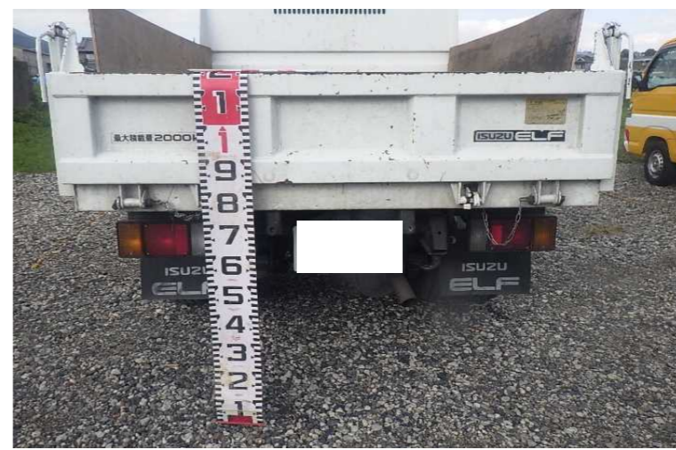
事故状況写真③ (荷台の高さH=1.15m)
