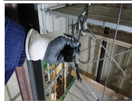
事故状況写真④ (ワイヤー切断部分)
