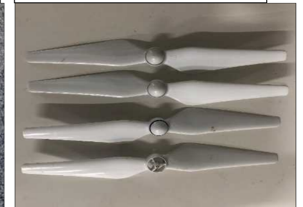
事故状況写真② (損傷したプロペラ)
