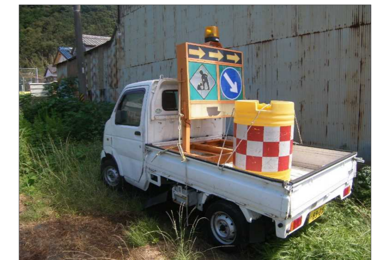
事故状況写真② (越波で流され横転した規制車)
