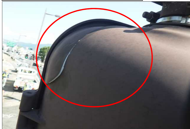
事故状況写真② (一部破損した信号カバー)
