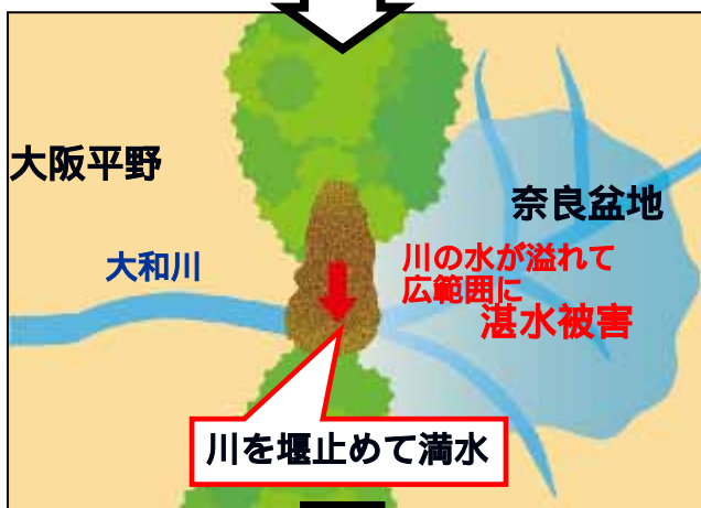
上流域の湛水 奈良県側で被害
