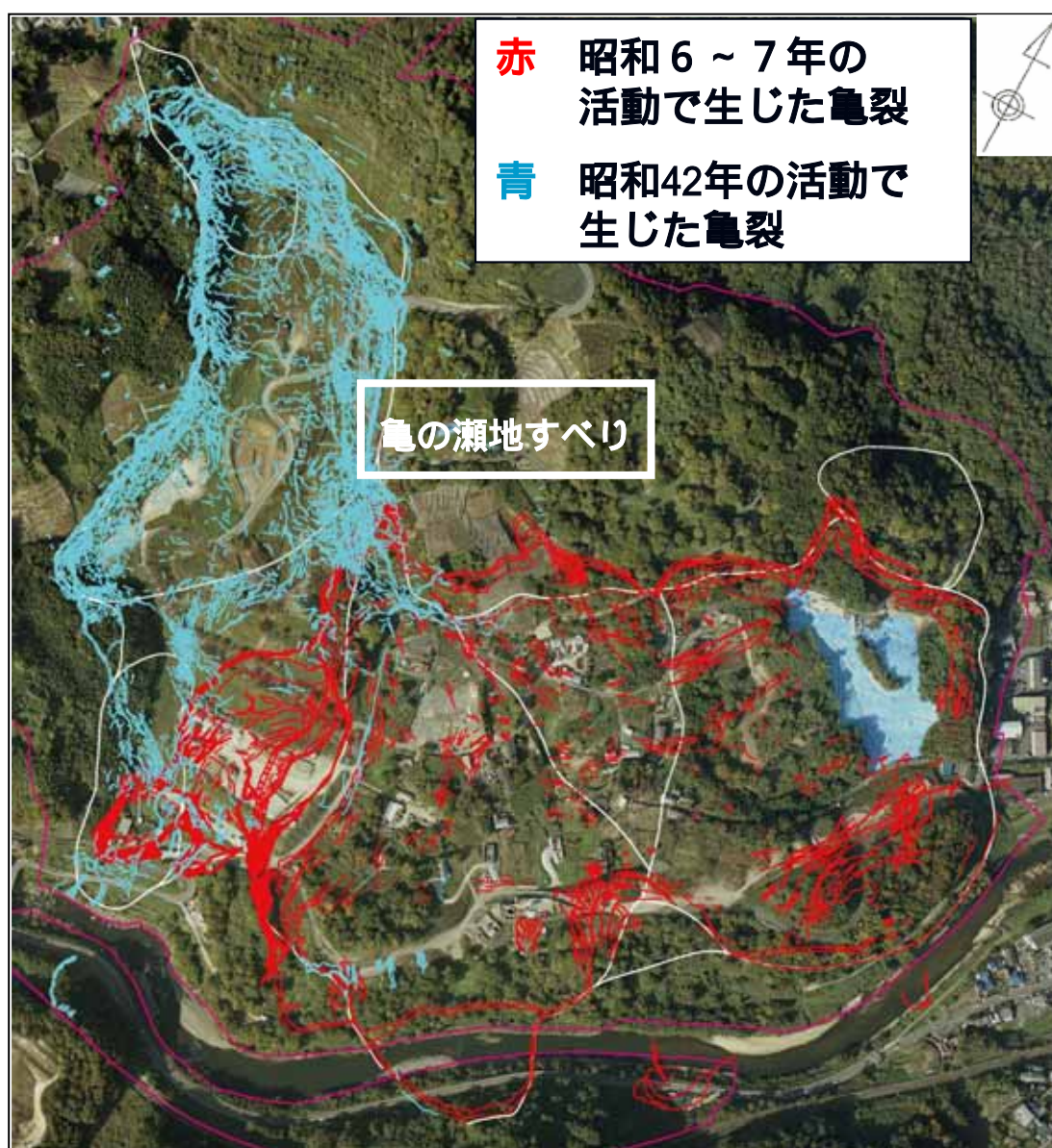
地すべり活動で生じた亀裂位置図 (赤：昭和6～7年の活動、青：昭和42年の活動)
