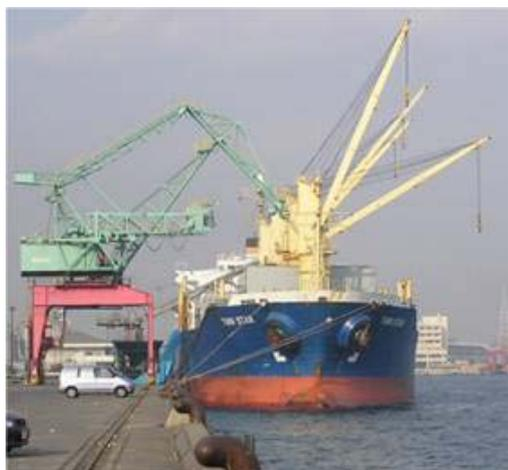
積み荷を小型船に積み替える等の喫水調整をした後に荷揚げする大型船。
