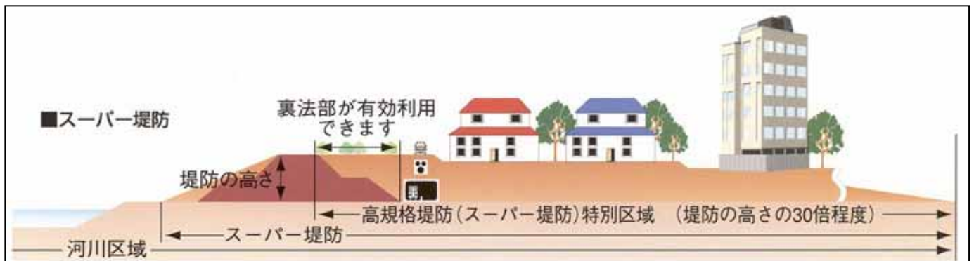
図 5-21 高規格堤防整備
