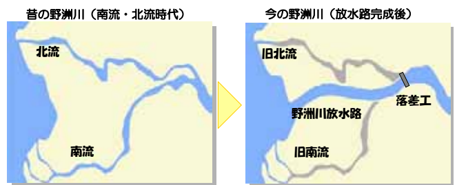
図 9-13 野洲川放水路建設に伴う流路の変遷
