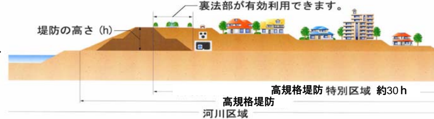
<高規格堤防整備後>
