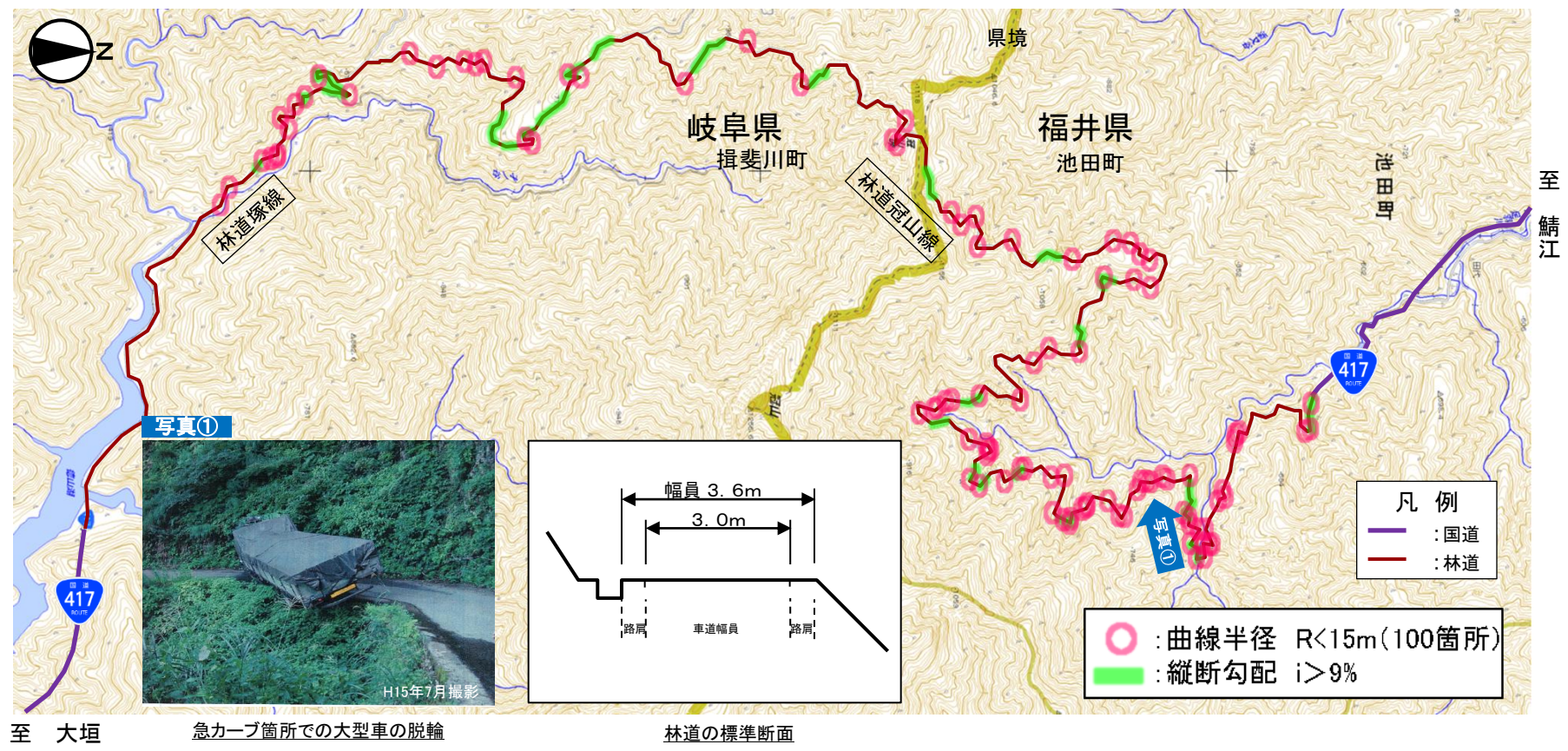
【林道(代替路)の線形状況】
