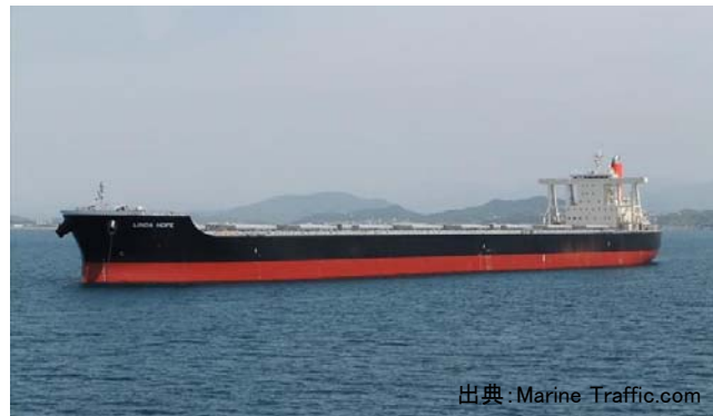
和歌山下津港に寄港している「LINDA HOPE」 (全長292m、船幅45m、載荷重量トン18.1万DWT)
