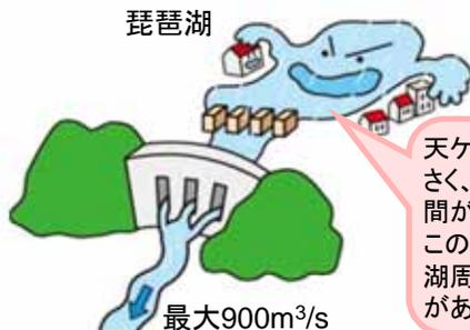
天ヶ瀬ダムの放流能力が小さく、琵琶湖の水位低下に時間がかかってしまう。このため大雨の場合、琵琶湖周辺の洪水被害の可能性が大きい。
