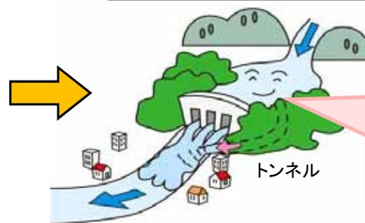
下流河道の流下能力向上とあわせて、天ヶ瀬ダムからの放流量を安全に増加させることで、洪水時の貯水容量を効率的に活用できるようになり、宇治川や淀川本川への洪水調節機能が強化される。
