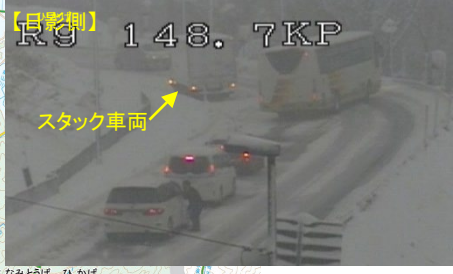
笠波峠(日影側)の急勾配(約8%)区間で大型車がスタック。迂回路がないため峠の両側で滞留車が発生
