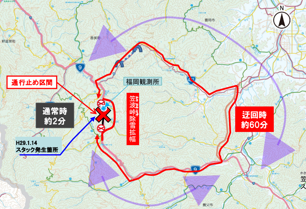
笠波峠(日影側)の急勾配(約8%)区間で大型車がスタック。迂回路がないため峠の両側で滞留車が発生
