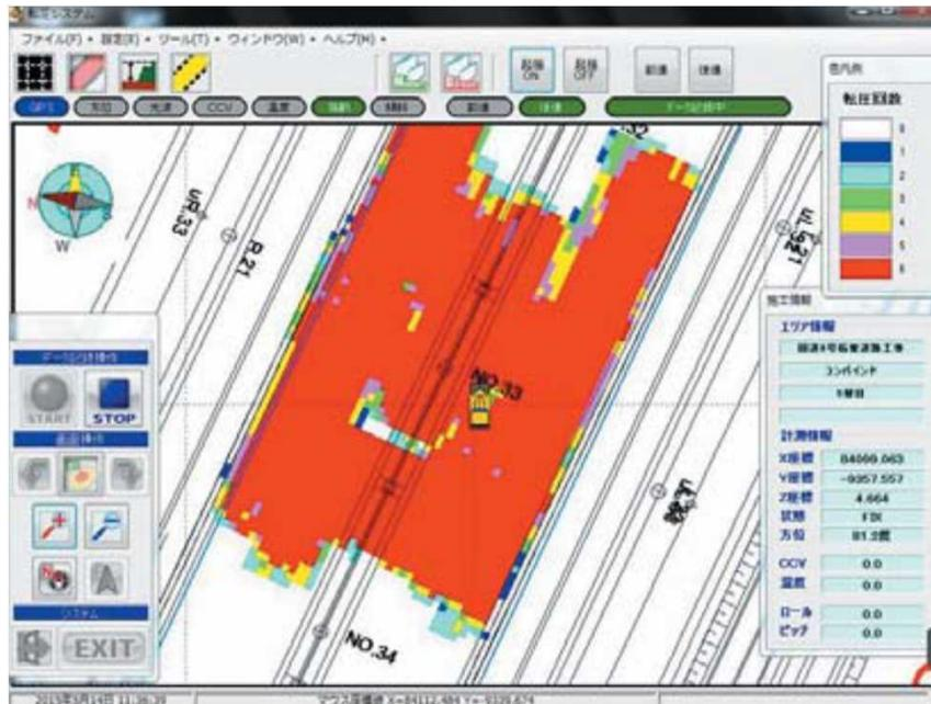
i-ConstructionにおけるICT活用工事においても盛土が伴う工事には原則「TS・GNSSを用いた盛土の締固め管理要領」に定められた管理方法を使用することになっています
