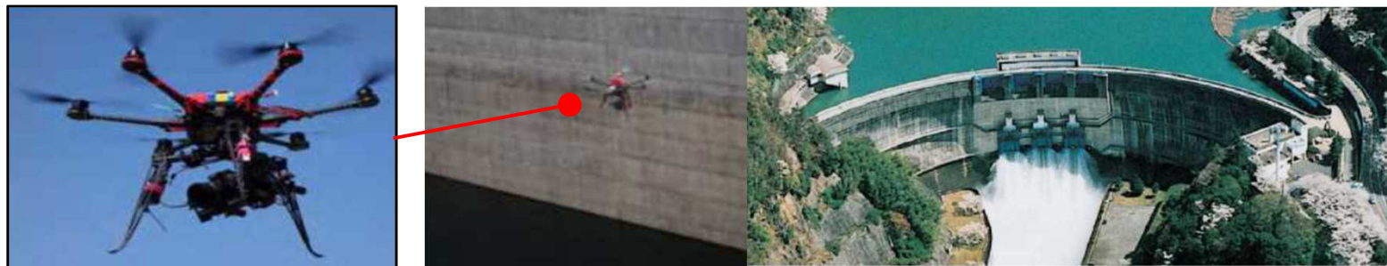
ドローンによるクラック調査の向上(イメージ)
