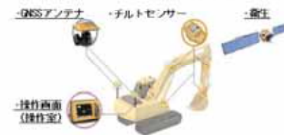
【ICT建設機械による施工】
