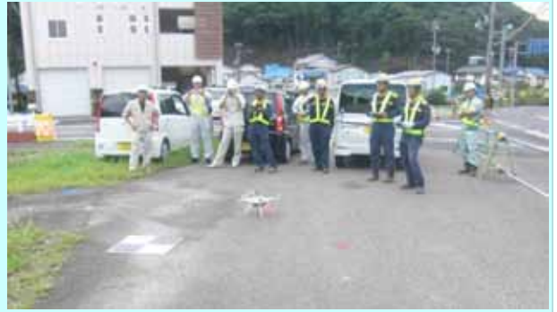
UAVによる起工測量
