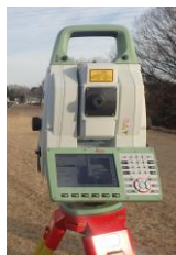
例) 1秒精度で計測 できるTS (Leica MS60)
