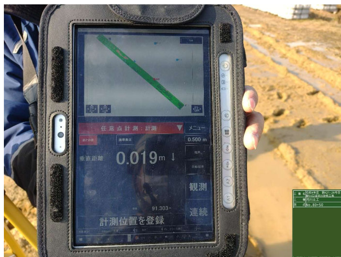
出来形計測（検証） （左：検測状況 右：検測結果）
