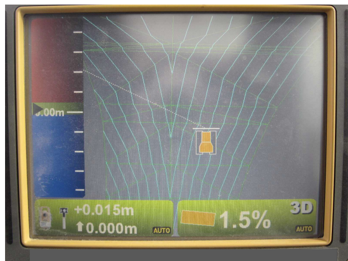
ICT建設機械MCブルドーザ (左：施工状況 右：施工中のモニター画面)
