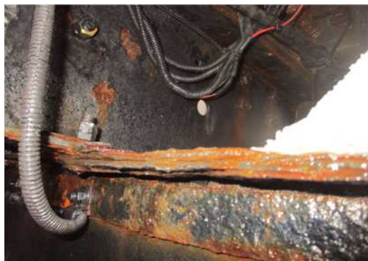
車体下部の錆 (詳細)
