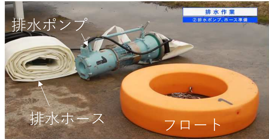
排水ポンプ車に搭載されている装備品
