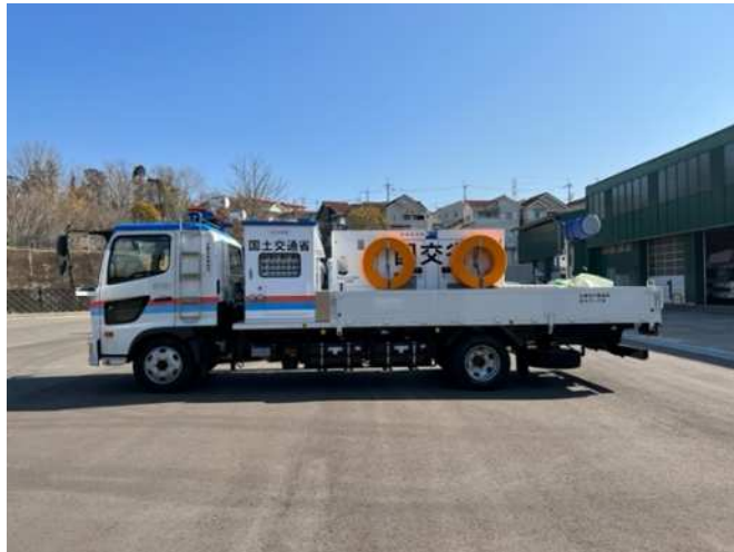
排水ポンプ車
