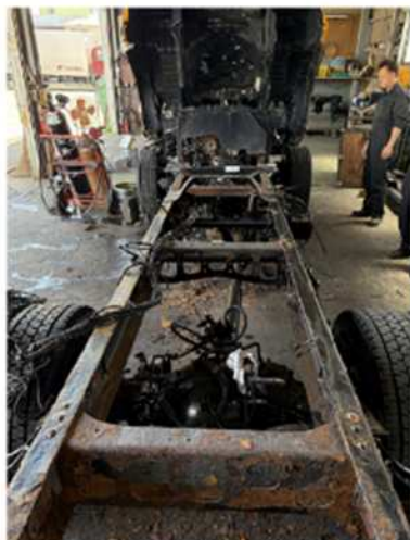
車体下部の錆 (全体)
