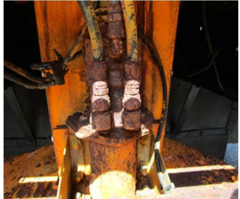
残った塩化ナトリウムにより、激しい劣化（錆等）が発生
