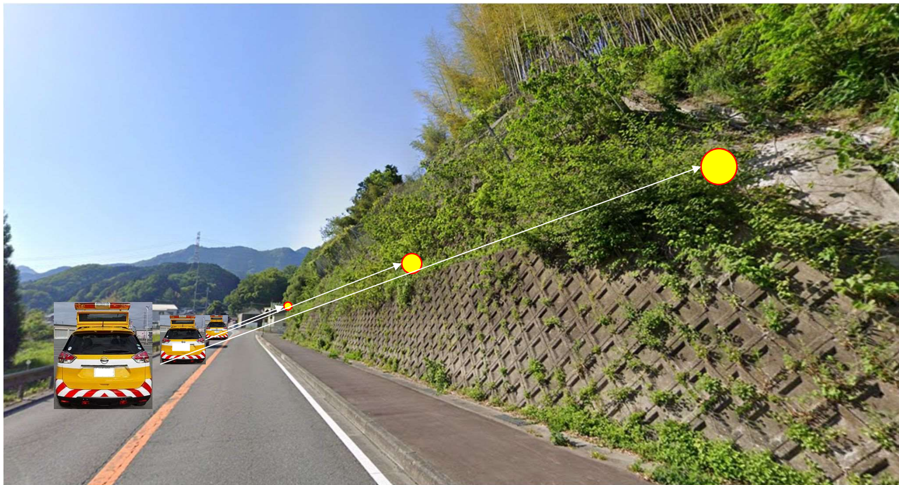
○イメージ図（一例：ロードパトロール車からレーザーによる変位計測）
