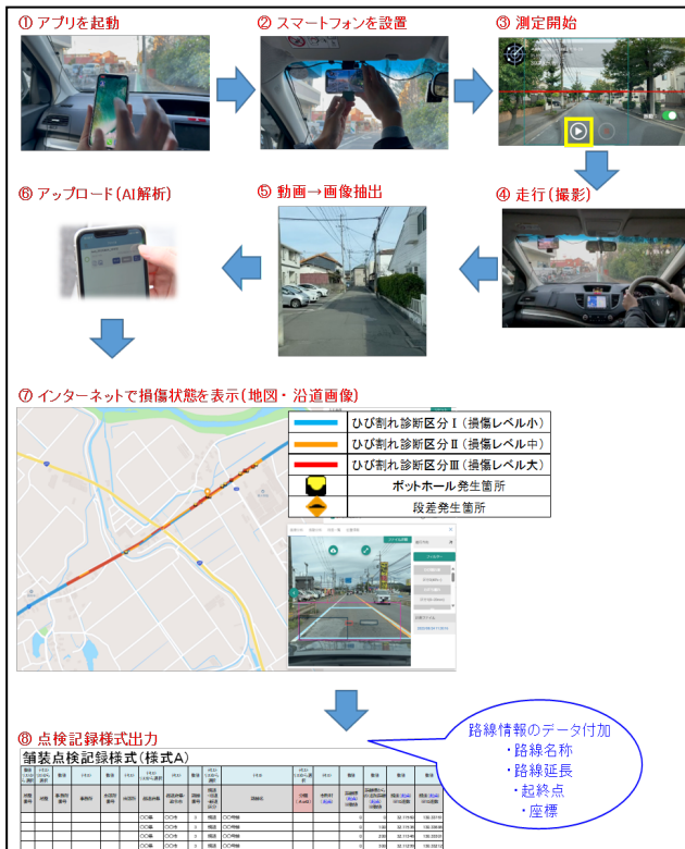
図-7 舗装点検手順
